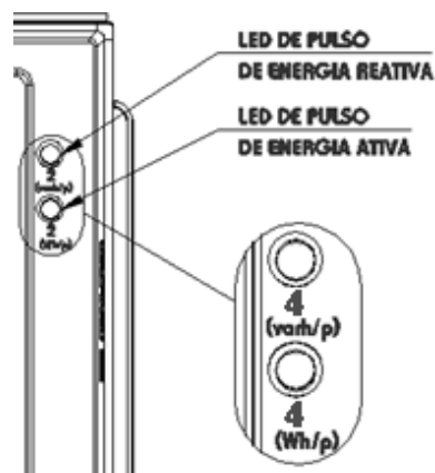
Figura 4.1 – Localização dos LEDs de calibração de energia ativa e reativa.
