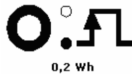
Figura 4.1- LED a esquerda – energia ativa
