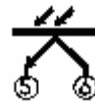
Figura 2.9 – Símbolo indicador de presença de saída de pulsos e em quais terminais os pulso serão disponibilizados no ELO2106L
